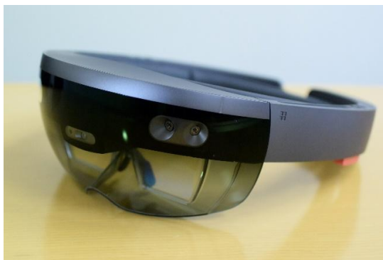
「HoloLens」（左）をかけることによって、 現実空間に、仮想物体である「ホログラフィックス」を 重ねて表示させることが可能に（右）
