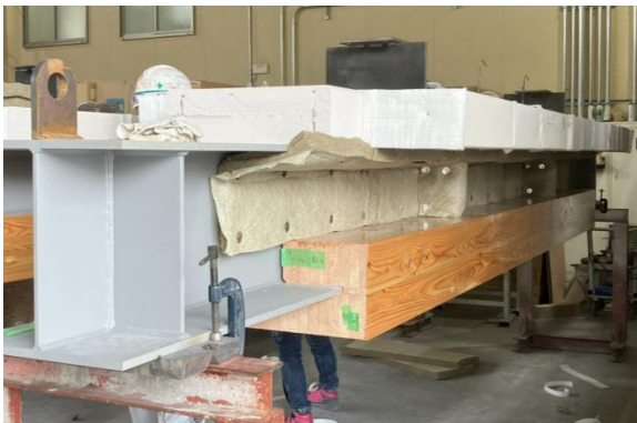
H 形鋼の下端に集成材を挟み込む構成により、鉄骨の補剛と耐火被覆を併せ持つ部材。集成材が被らない範囲は、無機繊維フェルトにて被覆
